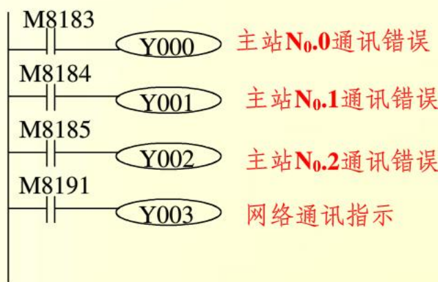
图11-22 例3网络通讯错误报警程序
