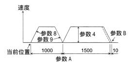
加速度由参数8和参数9决定。 操作速度由参数4决定(最大速度)。
