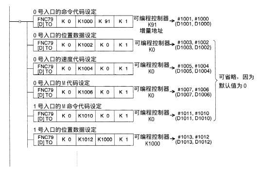
初始化表时,可能激活监视计时器(WDT),并且 CPU 可能产生错误。遇到这样的情况,在寄存器 D8000(监视计时器)中设定一个大的值,并在程序中插入 FNC07(WDT)指令,以使 WDT 在 100 ms 内刷新。
