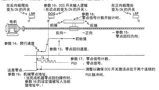
1 从驱动单元发送到定位单元的零点信号脉冲(PGO)数目被进行计数,当此计数值 达到一个给定值时,操作停止。通常,电机每转一转发出一个零点脉冲。
