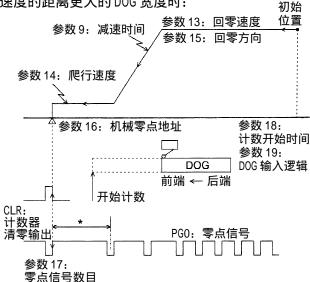
\* 调整以确保 DOG 开关激活点位于两个连续的 PGO 脉冲 之间的时间内。DOG 宽度必须比定位装置减速距离宽。
