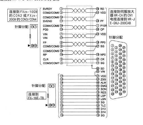
• 当从定位单元 / 扩展模块 / 端子板连接(接合)的一端看连接器时,上图表示了此时针脚的分配。
