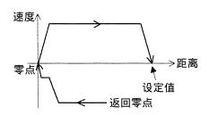
4)程序 说明 行号 指令 如果回零完成标志 M9057 接通, 即跳转至 P0。 Ox0, N0 LD M9057: N1 FNC00(CJ) P0; 使定位器返回零点。 N2 cod28(DRVZ); N3 P0; cod00(DRV) xDD100; 使定位器移动至由 D101 和 D100 规定的位置。 N4 D101和D100与缓冲存储器#101和#100相对应。 N5 m02(END); 数据用 TO 指令从 PLC 传输。
