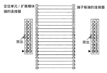
• 当从定位单元 / 扩展模块 / 端子板连接(接合)的一端看连接器时,上图表示了此时针脚的分配。
