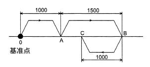
在上述示例中,显示出与在绝对驱动法中阐述相当的运行状况。此时,点 A 位于距初始位置 "+1000" 处。点 B 位于距 A 点(基准点)"+1500"(增量位移)处。同样道理,点 C 位于距 B 点(基准点)"-1000" 处。
