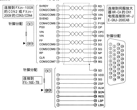
• 当从定位单元 / 扩展模块 / 端子板连接(接合)的一端看连接器时,上图表示了此时针脚的分配。
