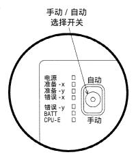
手动操作时定位此开关到"MANU",自动操作时则定位到"AUTO"。
