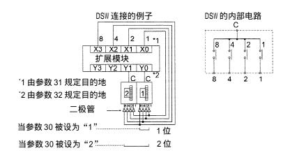
当参数 30 被设为 "2"时,在数字开关上加装一个 50V,0.1A 的二极管,以防止循环路径。
