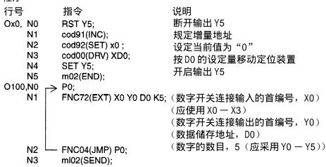
为了读取数字开关,应该用参数 33 设定数字转换时间(初始值= 20ms)。 当  $FX_{2N}$ - 10GM/20GM 主机身上连接有数字开关时,该转换时间固定在"7ms"。结果缩短了运行时间。
