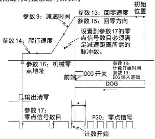
调整以确保 DOG 开关激活点处于两个连续的 PGO 脉冲之间的时间内。为便于调整,必须取尽可能慢的零点返回速度。
