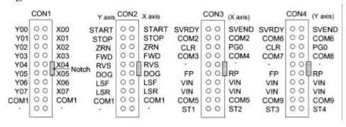
所有具有相同名称的端子是内部连通的。(如 COM1 - COM1 , VIN - VIN , 等)不要连接"•"端子。
