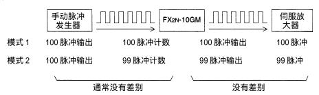
在  $FX_{2N}$ -10GM 中,手动脉冲发生器的脉冲输出数目和  $FX_{2N}$ -10GM 计数(模式 2)的脉冲数目间的差别很少出现。
