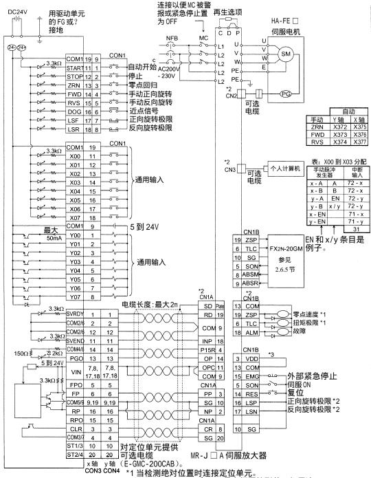
\*2CN1A, CN1B, CN2 和 CN3 具有相同的形状。如果连接时搞混,就可能发生故障。
