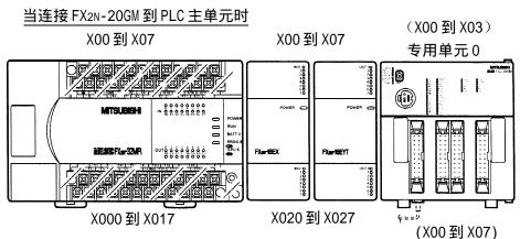
( ) 内显示的 I/O 分配表示 FX<sub>20</sub>-10GM 中的 I/O 点。
