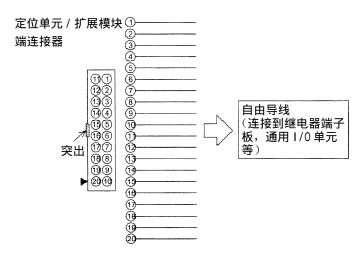
• 当从定位单元 / 扩展模块 / 端子板连接(接合)的一端看连接器时,上图表示了此时针脚的分配。
