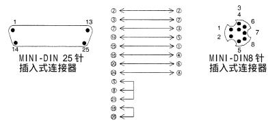
连接电缆FX-50DU-CABO, FX-50DU-CABO-1M, FX-50DU-CABO-10M, FX-50DU-CABO-20M, FX-50DU-CABO-30M, FX-50DU-CABOL
