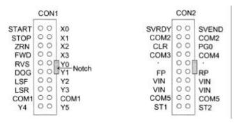
所有具有相同名称的端子是内部连通的。(如 COM1-COM1, VIN-VIN, 等)不要连接"。"端子。
