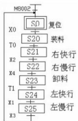
图 3.2 运料小车的状态示意图
