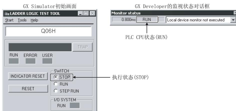
\*1: 在监视状态对话框中显示的 PLC CPU 状态以 SD 软元件的信息作为根据。
