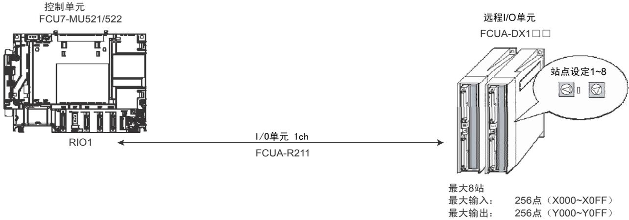
(注) 在各远程I/O单元上有决定单元编号的旋转开关, 与运行编号(X)(Y)有关。
