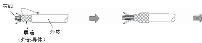
电缆的屏蔽线应按下图所示连接到插头的衬板上进行组装。
