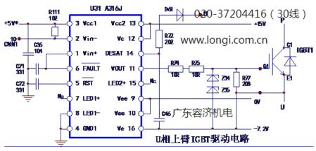
图 6 由 HCPL-316J 构成的驱动电路
